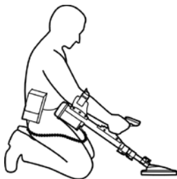
Slika 10: Spremnik za baterije odvojen od gornje drške
